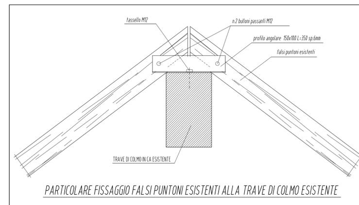
PARTICOLARE FISSAGGIO FALSI PUNTONI ESISTENTI ALLA TRAVE DI COLMO ESISTENTE
