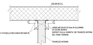
**PARTICOLARE COSTRUTTIVO NUOVI NUOVI PROFILATI IN ALLUMINIO DA INSTALLARE AL DI SOPRA DEI TRAMEZZI scala 1:10**
