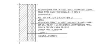
**PARTICOLARE COSTRUTTIVO ISOLAMENTO TERMICO A CAPPOTTO scala 1:10**
